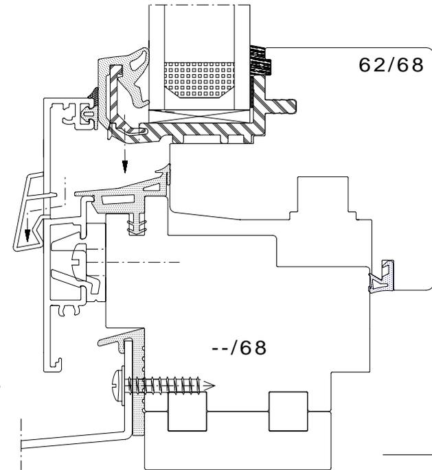
"Multiframe" bezieht sich im wahrsten Sinne des Wortes auf die große Vielfalt der äußeren Rahmenabdeckungen. Durch die Anwendung der WF-VARIO 3- Profile kann dem Holz-Alufenster eine Pfosten/Riegeloptik verliehen werden. Ein weiterer Vorteil ist die Tatsache, dass Festfelder dadurch von außen verglast werden können, d. h. keine Glasleistenherstellung und eine wesentliche Verbesserung der Statik bei geschosshohen Elementen.
